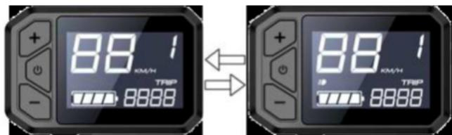
Appuyez deux fois sur le bouton "+" lorsque l'écran est allumé pour passer de Km/h à Mp/h et appuyez deux fois sur le bouton "-" pour passer de Mp/h à Km/h.
