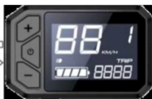
Houd 2 seconden de "+" en "M"-toets ingedrukt om de snelheid van km/h naar mph te veranderen en door tweemaal op de toets "-" te drukken wordt overgeschakeld van Mp/u op Km/u.
