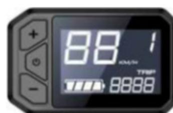
Une pression continue sur le bouton "+" ou "-" active la traction automatique à 6 km/h.
