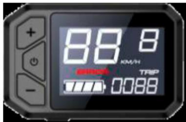
Die Fehleranzeige wird durch das blinkende Wort "ERROR" dargestellt.
