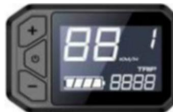
Durch ständiges Drücken der "-" Taste wird die automatische Traktion bei 6 km/h aktiviert.
