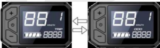
Appuyez sur le bouton "M" pour naviguer dans le menu et obtenir les informations. Distance totale. Distance parcourue. UNIQUEMENT MESURER kilomètre par kilomètre.
