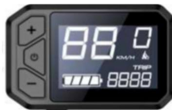
Door de "-" toets in te drukken wordt de 6 km/u automatische tractie continu geactiveerd.
