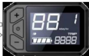
Durch zweimaliges Drücken der "+" Taste bei eingeschaltetem Display wird von Km/h auf Mp/h umgeschaltet und durch zweimaliges Drücken der "-" Taste mit eingeschaltetem Display wird von Mh/p auf Km/h umgeschaltet.
