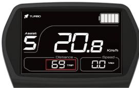
Das Display zeigt abwechselnd den TRIP- und ODO-Kilometerstand alle 20 Sekunden.
